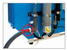
CONNECT THE OUTLET TUBE OF NITROX
